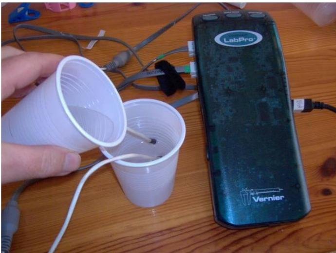
Quando i due termometri registrano praticamente la stessa temperatura, segno che l'equilibrio è stato raggiunto, si interrompe la misura cliccando sul tasto STOP
