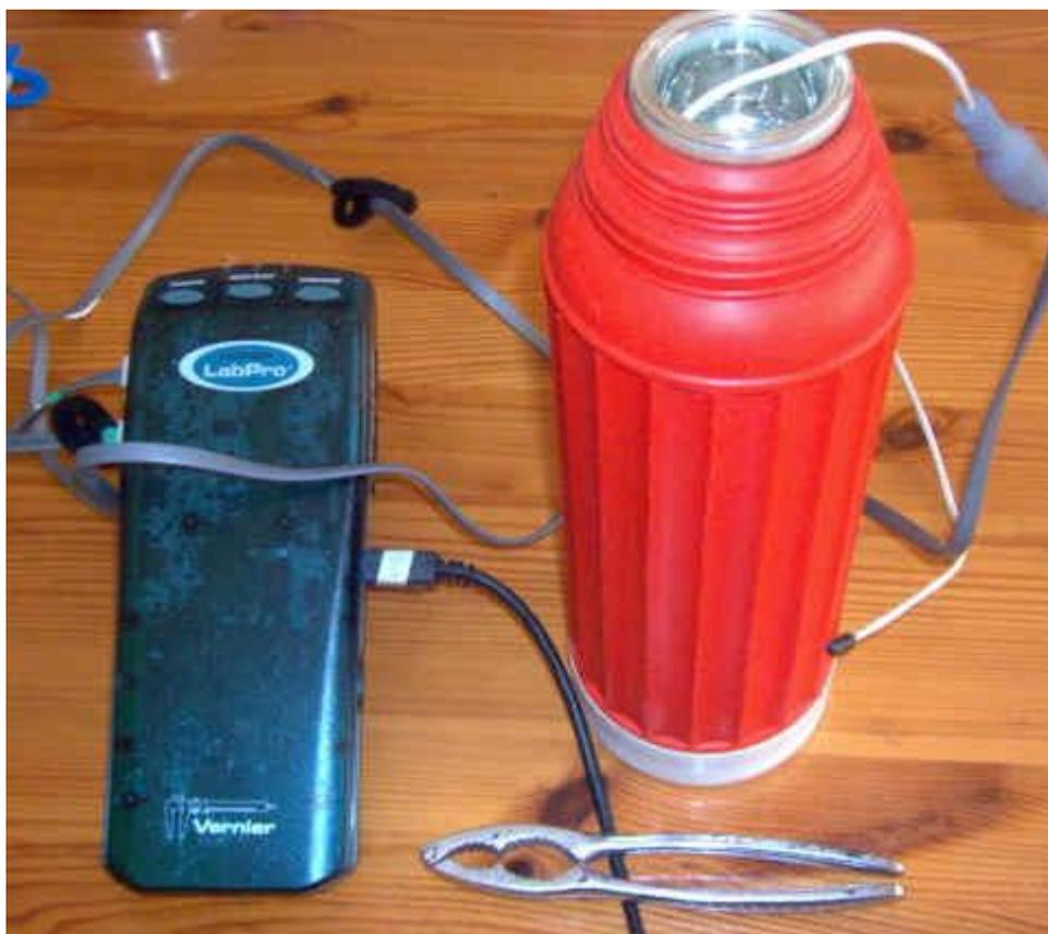
Quando le due temperature che appaiono sullo schermo si sono stabilizzate si dà il via al rilevamento cliccando sul tasto MISURA!
